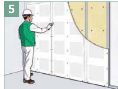
5 이음매 부위 조인트 컴파운드 시공
